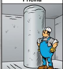
Trhliny v betonu se objevují u vysokých stěn a sloupů, u desek mohou kopírovat polohu výztuže.
