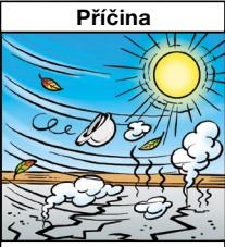
Trhliny od plastického smršťování vznikají v důsledku rychlého vypařování vody z povrchu betonu.
